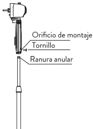
6. Para conectar la unidad principal al poste interno, afloje el tornillo en la parte inferior de la unidad principal. Coloque la unidad principal en el poste interno y apriete el tornillo alineado con la ranura en la columna extensible.
